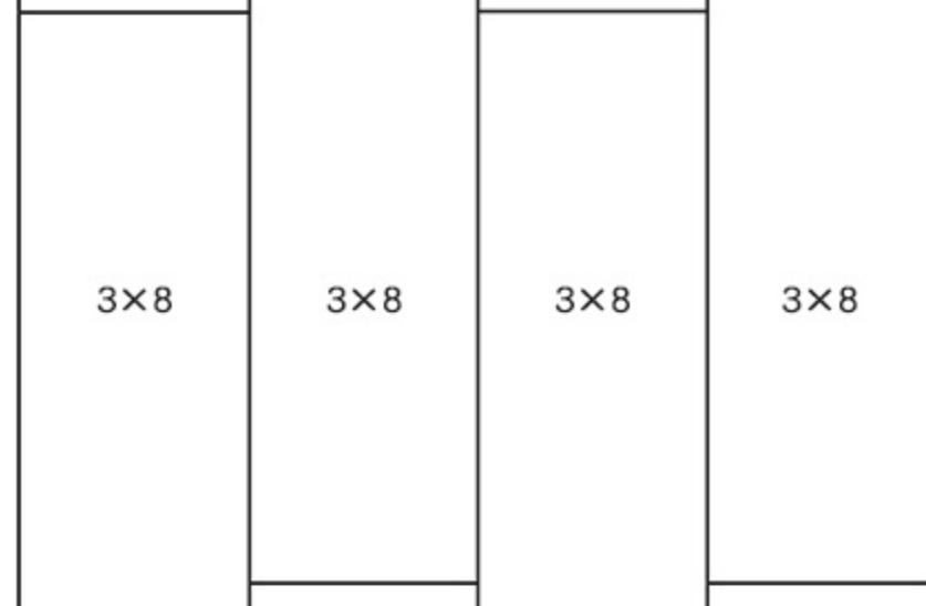
○吹き抜けにおける胴差し部分にボードのジョイントを持ってこないように施工して下さい。
